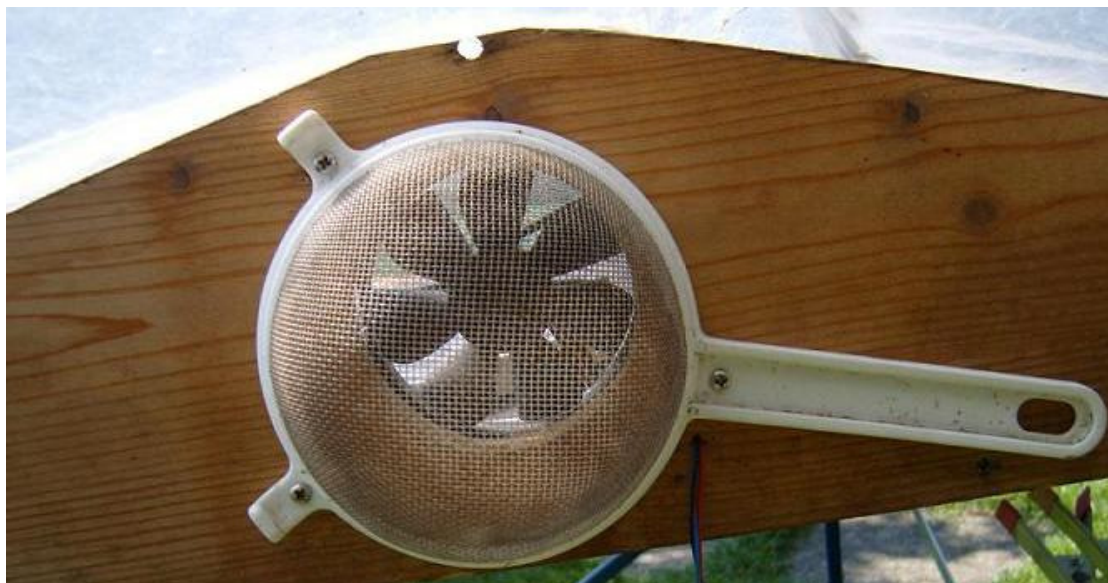
Fig 10 : Abdeckung des Ventilators
